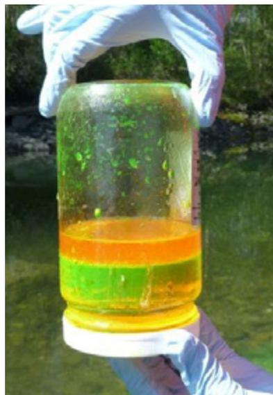
L'échantillon du liquide présent dans les fûts est prélevé dans un contenant en verre ambré pour effectuer des analyses organiques. Un deuxième échantillon peut être placé dans un bocal en verre clair pour montrer les différentes couches de produits chimiques. Cette technique est communément appelée « cocktail » et sert à cacher des déchets liquides dangereux de densité élevée (habituellement des substances organiques chlorées) sous une couche inoffensive.
