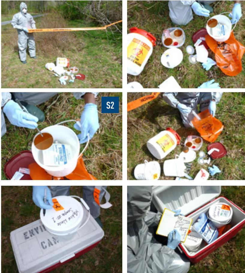
Utiliser de grandes pinces en acier inoxydable pour prélever les échantillons de déchets biologiques, les aiguilles ou les objets pointus ou tranchants. Entreposer dans des contenants transparents en plastique et résistant aux perforations ou dans des seaux scellables en plastique à large ouverture, ou photographier pour attester de leur présence.
