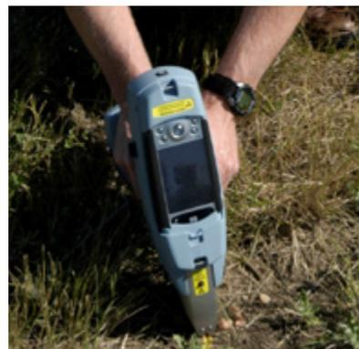
Un échantillonnage ponctuel avec un appareil portatif par fluorescence à rayons-X permet de déterminer rapidement les zones contaminées par des métaux.
