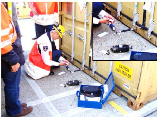
Essai pour vérifier la présence de gaz toxiques avec un détecteur de gaz à photolionisation avant d'ouvrir un contant d'expédition.
