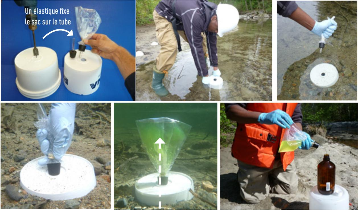
**Option 2** Échantillonnage à l'aide de piézomètres peu profonds
