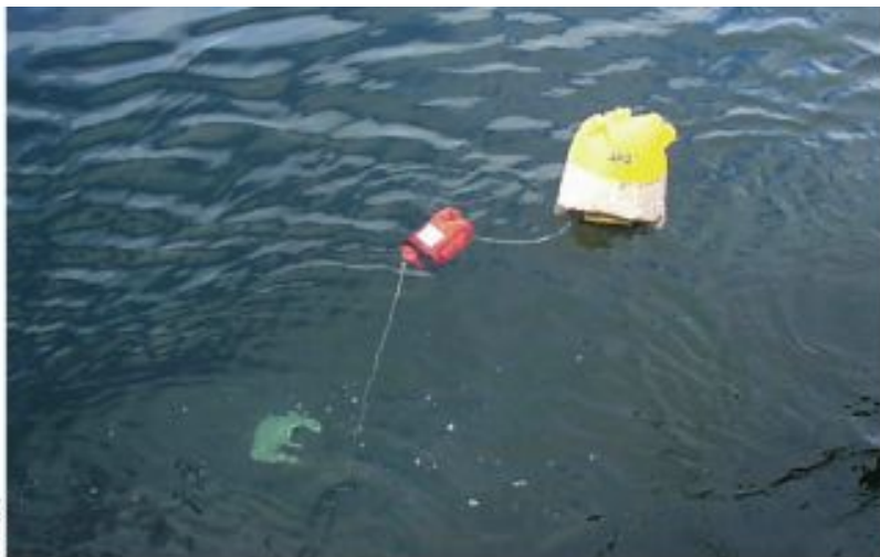
28. Boya de toma de muestras que puede lanzarse desde un avión de vigilancia, desarrollada en cooperación con la Guardia Costera de Suecia.
