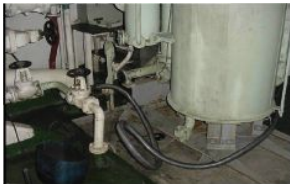
15. Dispositivo sanitario marino con tuberías de descarga de aguas sucias al mar.
