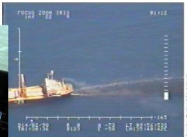
27. Secuencia de vídeo de una aeronave de vigilancia dedicada a la detección de vertidos. La imagen graba automáticamente la fecha, hora y la posición.
