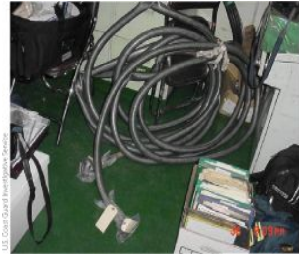
12. Tubo flexible de bypass de 40 pies con restos de hidrocarburos.
