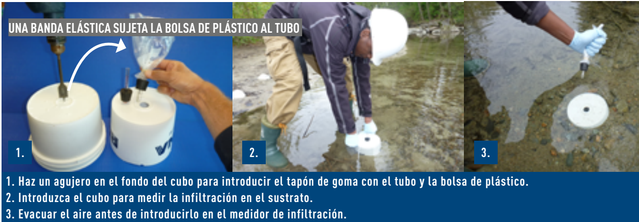
FIGURA 6.11 : Construcción e instalación de un dispositivo de medición de infiltraciones. (Cortesía del DOE de Canadá)
