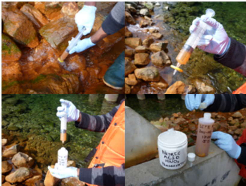
FIGURA 6.16 : Jeringa y filtro de 0,45 micras para tomar una muestra de agua para el análisis de metales disueltos. (Cortesía del DOE de Canadá)
