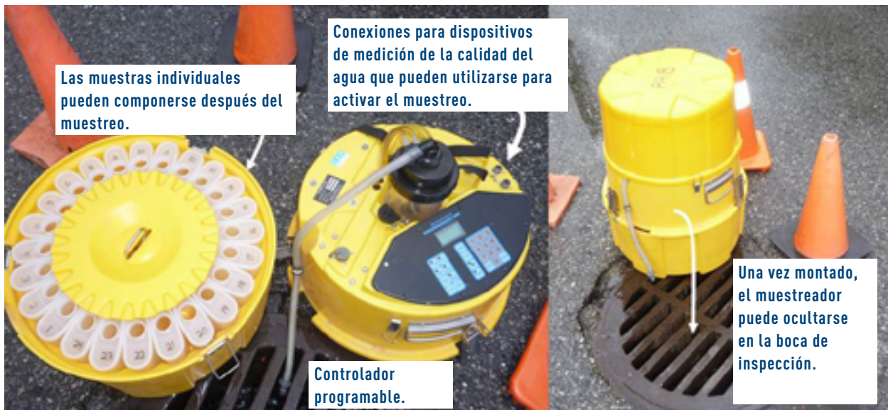
FIGURA 4.1 : Muestreador automático que puede programarse para tomar muestras individuales o compuestas a intervalos regulares o irregulares, o ser activado por la calidad del agua (pH, temperatura, oxígeno disuelto, conductividad, caudal, etc.) (Cortesía del DOE de Canadá)
