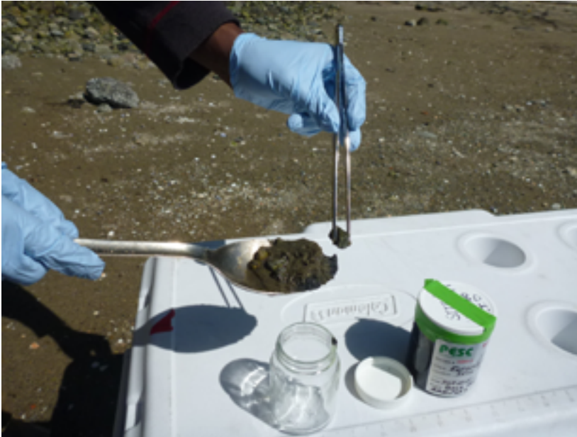
FIGURA 7.2 : Cuando recoja una muestra de sedimento, intente recoger material uniforme y de grano fino. Retire las piedras grandes o los restos leñosos que no puedan ser digeridos. (Cortesía del DOE de Canadá)
