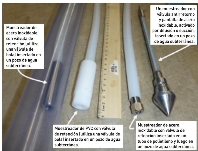
FIGURA 6.15 : Bombas con válvula antirretorno y filtro de aspiración que pueden utilizarse para extraer agua subterránea de los piezómetros. (Cortesía del DOE de Canadá)
