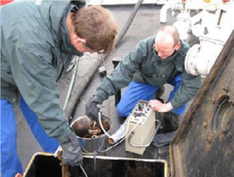
FIGURA 6.7: Muestra tomada en un tanque refrigerado mediante una bomba peristáltica. Nota: En presencia de vapores peligrosos, se requiere el uso de un respirador. (Cortesía de NFIT des Pays-Bas)
