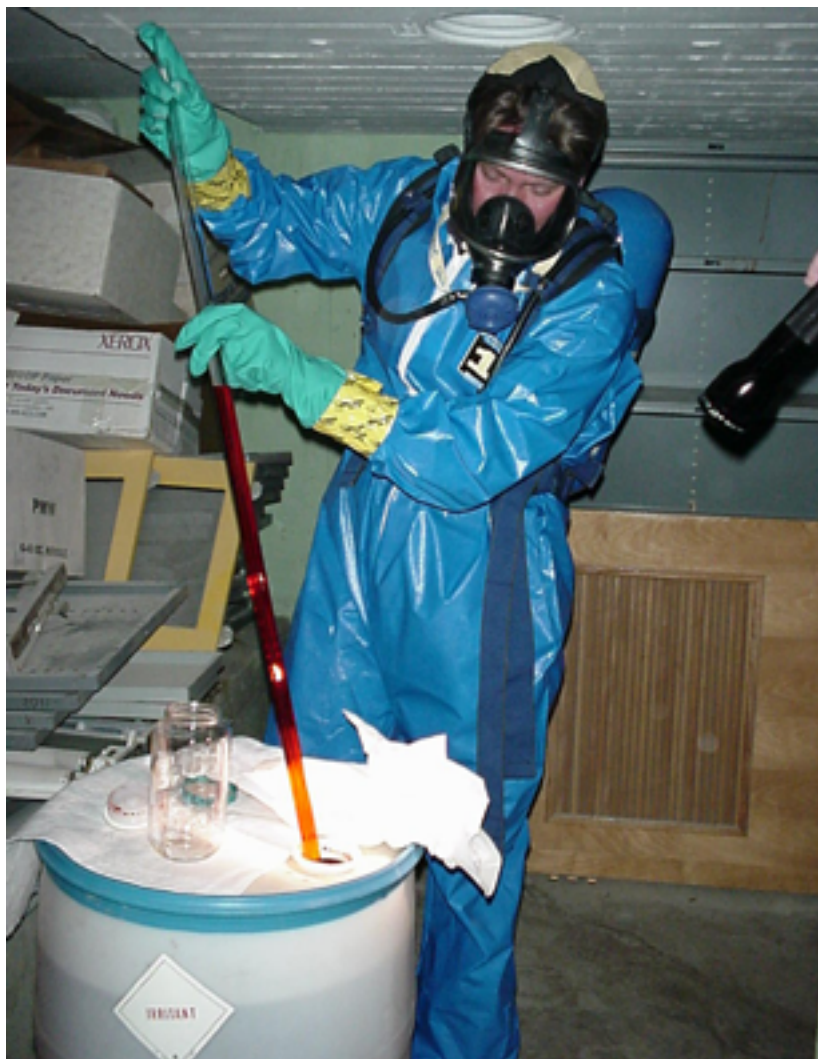
FIGURA 4.2 : El tubo de vidrio exterior recoge la muestra y el tubo de vidrio interior está provisto de un tapón para evitar que la muestra se escape. (Cortesía de EPA de Estados Unidos)
