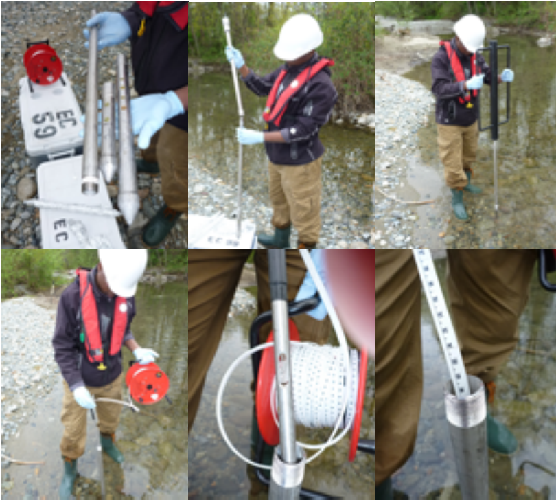
FIGURA 6.13 : Instalación de piezómetros poco profundos mediante un martillo de inercia y medición de la elevación de las aguas subterráneas. (Cortesía del DOE de Canadá)
