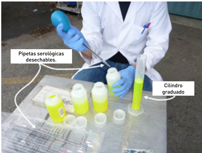
FIGURA 6.3 : Las muestras individuales pueden agruparse en una muestra compuesta mezclando y decantando las muestras o utilizando pipetas serológicas desechables graduadas o un recipiente graduado para dividir las muestras individuales en submuestras. (Cortesía del DOE de Canadá)
