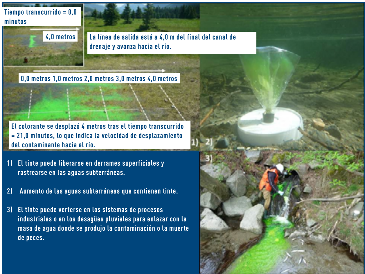
FIGURA 3.6 : Secuencia de fluoresceína para evaluar el flujo de infiltración y la relación con los vertidos industriales y las alcantarillas. (Cortesía del DOE de Canadá)
