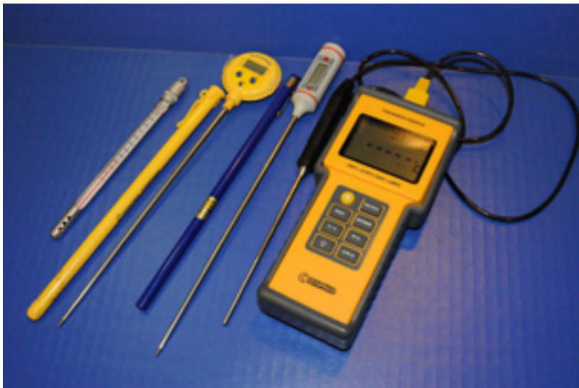
FIGURA 3.3 : Las sondas de temperatura van desde simples termómetros de vidrio en una carcasa de acero inoxidable para una sola medición, hasta sondas de medición múltiple que permiten el registro de datos. (Cortesía de EPA DE ESTADOS UNIDOS y del DOE de Canadá)
