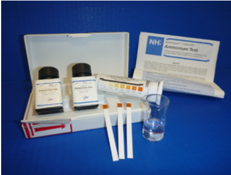
FIGURA 3.4 : Los kits de análisis de amoníaco portátiles son muy útiles para las mediciones sobre el terreno, ya que el amoníaco es volátil y debe medirse lo antes posible. (Cortesía de DOE de Canadá)
