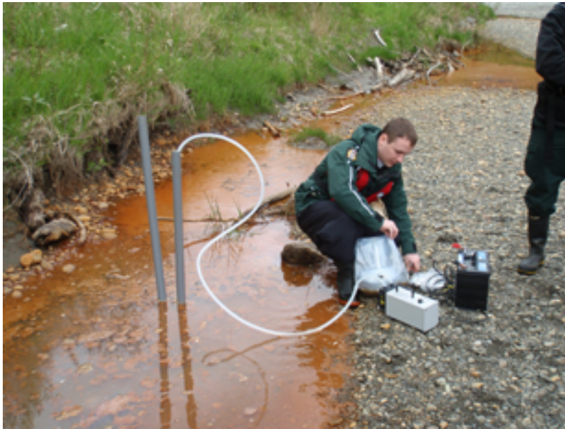
FIGURA 6.14 : Muestra tomada de un piezómetro poco profundo utilizando una bomba peristáltica. (Cortesía del DOE de Canadá)
