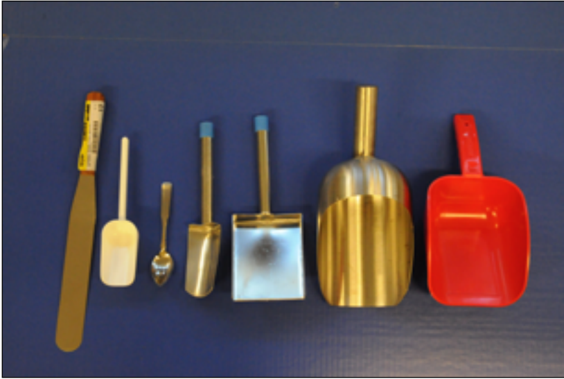
FIGURA 4.10 : Cucharas de muestra típicas de acero inoxidable reutilizables y de plástico desechables. (Cortesía de EPA de Estados Unidos y del DOE de Canadá)
