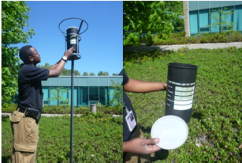
FIGURA 8.2 : La cubierta del muestreador de polvo se quita y se vuelve a colocar (Cortesía del DOE de Canadá)
