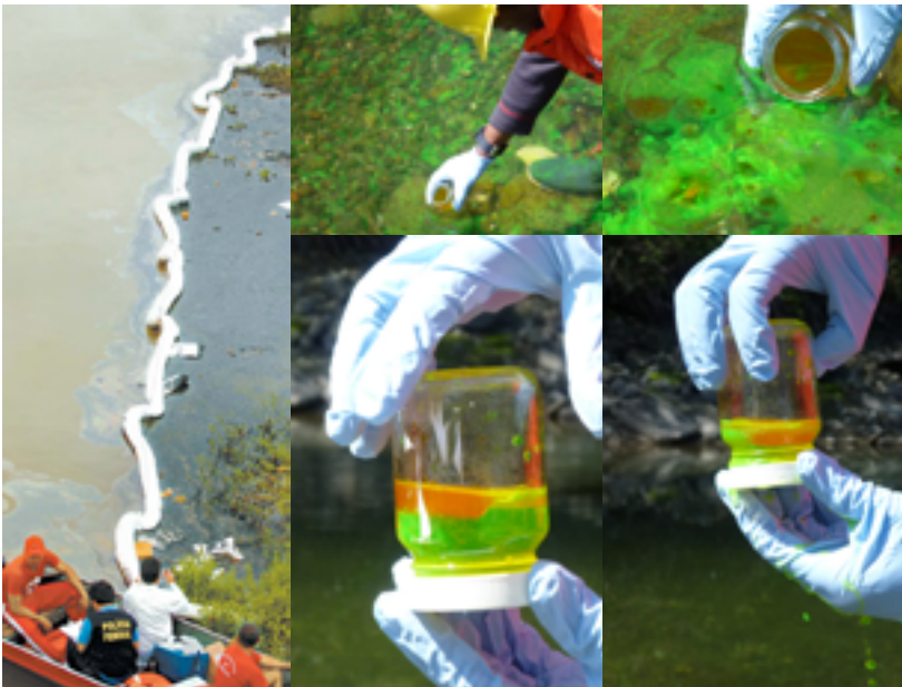
FIGURA 6.5 : Muestreo de líquidos flotantes y productos petrolíferos. (Cortesía de Policía Federal de Brasil y del DOE de Canadá)
