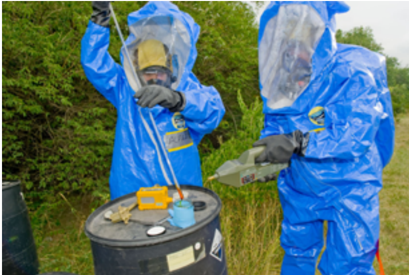
FIGURA 6.6 : Uso de un detector de vapores de gas y un muestreador de residuos líquidos compuestos (Coliwasa) para tomar una muestra de una sustancia desconocida de un barril (Cortesía de EPA de Estados Unidos)
