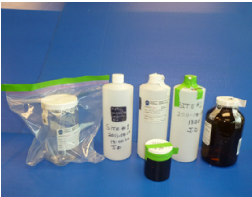
FIGURA 11.1 : Antes del envío, todas las muestras exigidas por la ley deben sellarse con cinta adhesiva a prueba de manipulaciones con las iniciales escritas en ella. (Cortesía del DOE de Canadá)
