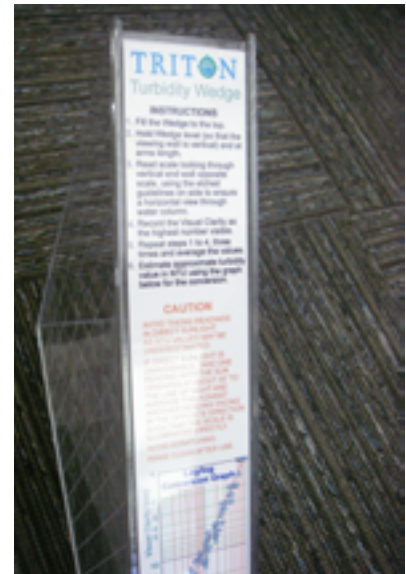
FIGURA 3.5 : Métodos sencillos de campo para medir la turbidez (Cortesía de De Genesis Environmental Sciences Ltd y de Triton Environmental Consultants Ltd.)
