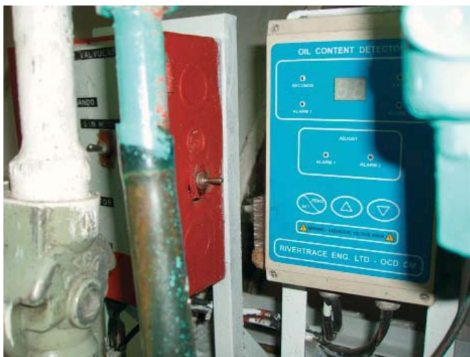
21. Interrupteur installé pour neutraliser l'alarme du détecteur d'hydrocarbures et permettre au séparateur de continuer à fonctionner même si la teneur en hydrocarbures dépasse 15 ppm.
