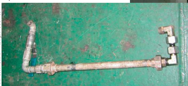
13. Tuyau pré-dimensionné adapté présentant des traces de résidus d'hydrocarbures trouvés dans un magasin.
