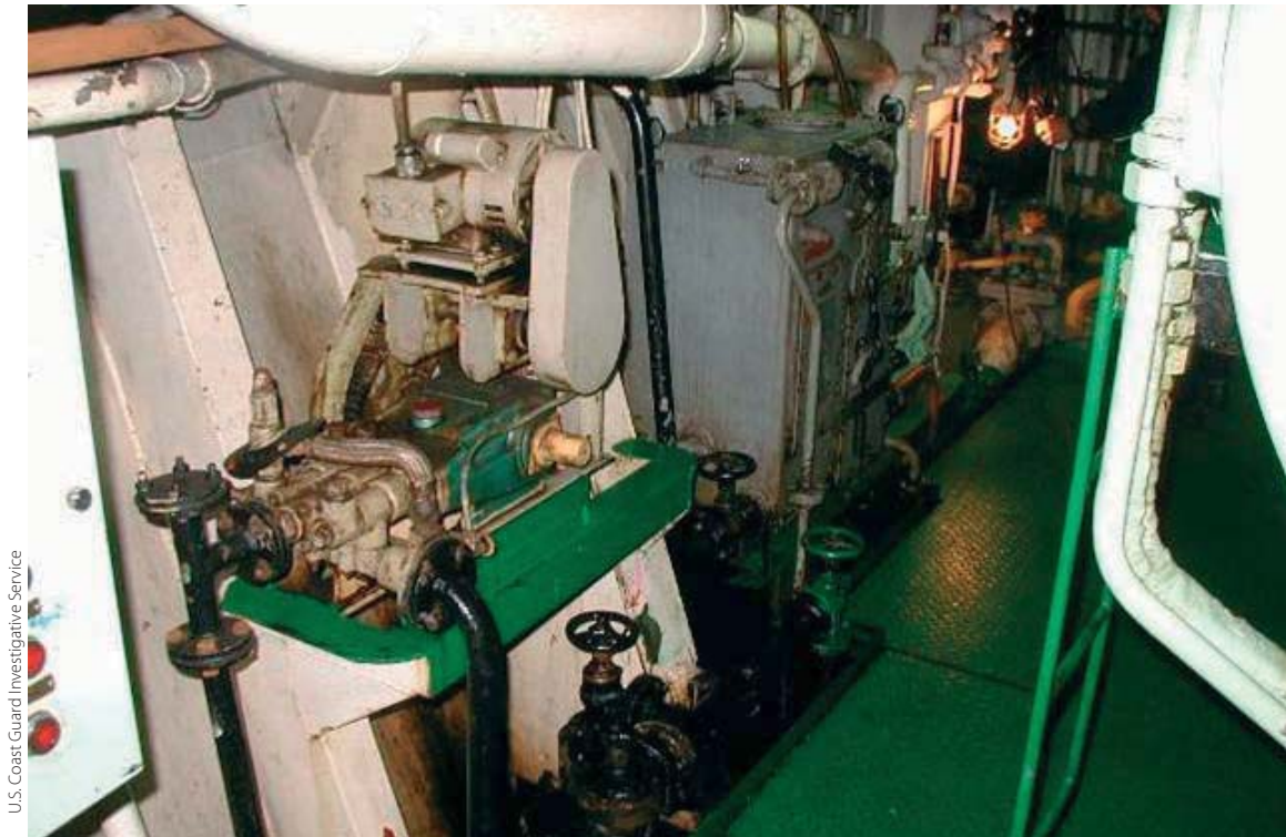
9. Raccord en T obturé sur le refoulement de la pompe de cale.
