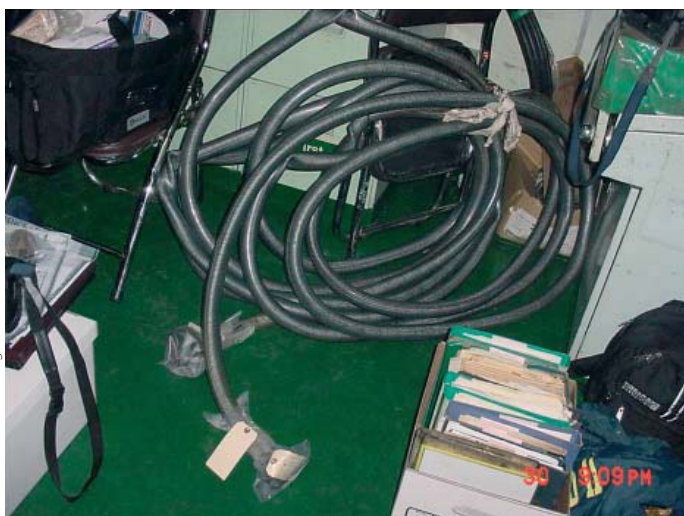
12. Résidus d'hydrocarbures trouvés dans un tuyau souple d'une longueur de 12 mètres environ.
