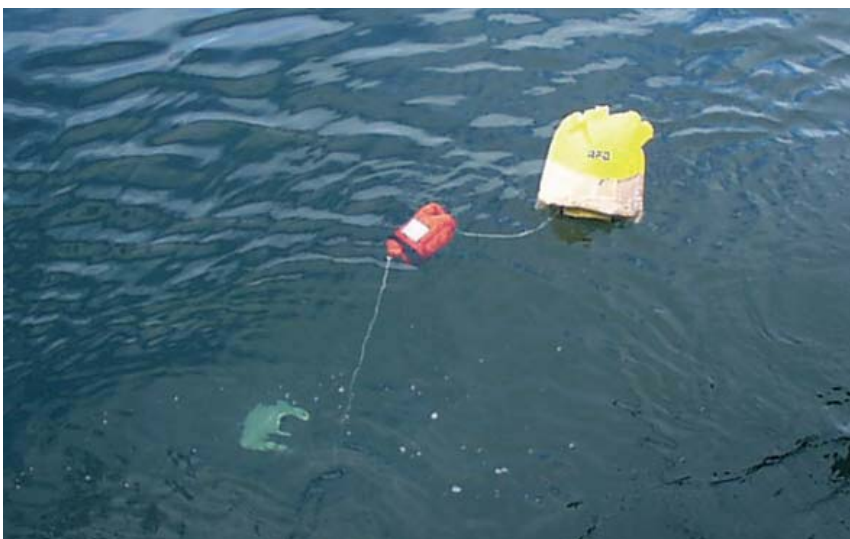
28. Bouée d'échantillonnage pouvant être larguée depuis un aéronef de surveillance aérienne, mise au point en coopération avec le Service suédois des gardes côtes.
